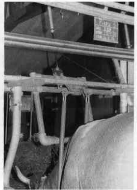
Fotos 7, 8. Der pneumatisch bewegte Bügel mit geradliniger Steuerung auf den Nackenbereich zeigt eine sehr gute Wirkung.
