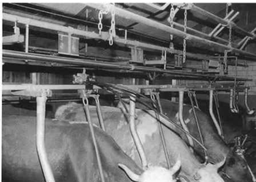
Foto 1. Mit einem Scheibenwischermotor und angebauten elastischen Kunststoffröhren wurde ohne Erfolg versucht, die Kuh zurückzudrängen.
