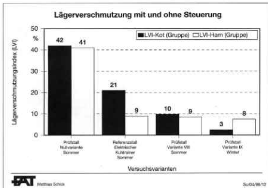
Abb. 6. Die Lägerverschmutzung kann durch die an der FAT entwickelte wirksame Kuhtraineralternative stark reduziert werden, ohne dass ansonsten eine Verhaltenseinschränkung durch die Steuerung stattfindet.
