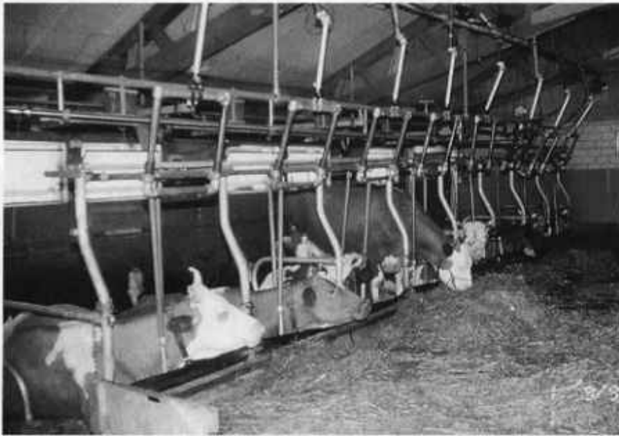
Fotos 7, 8. Der pneumatisch bewegte Bügel mit geradliniger Steuerung auf den Nackenbereich zeigt eine sehr gute Wirkung.
